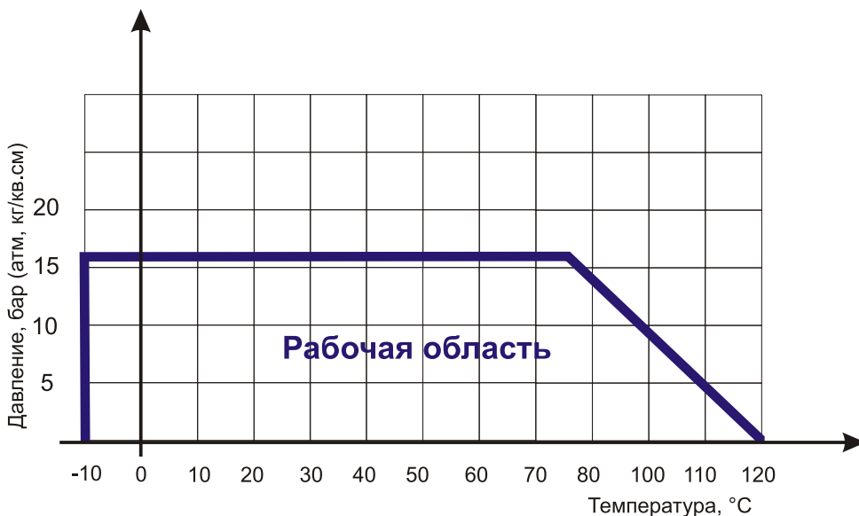
Диаграмма Давление / Температура для задвижки клиновой ABRA-A40-16G с обрезиненным клином и невыедным штоком DN 40-600 PN 16:
